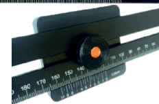
Nonius 1/20 mm odečet 1/20 mm
