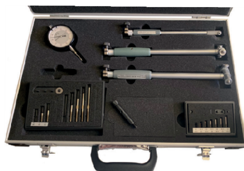
Messbolzen aus Stahl, gehärtet, Werkstattausführung měřicí plochy z oceli, kalené dle firemní normy
